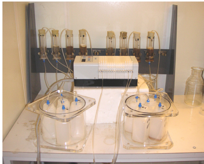
Figur 2 Kolonnförsöket med kolonner (överst), slangpump (mitten) och vakuumbkammare (nederst).
