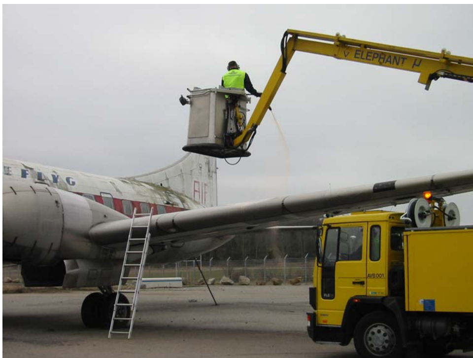
Figur 9: Simulerad avisning för bestämmandet av avisningsvätskans filmtjocklek, på Bromma flygplats år 2004. Flygplanet är ett Convair. (Foto: S.Ljung)
