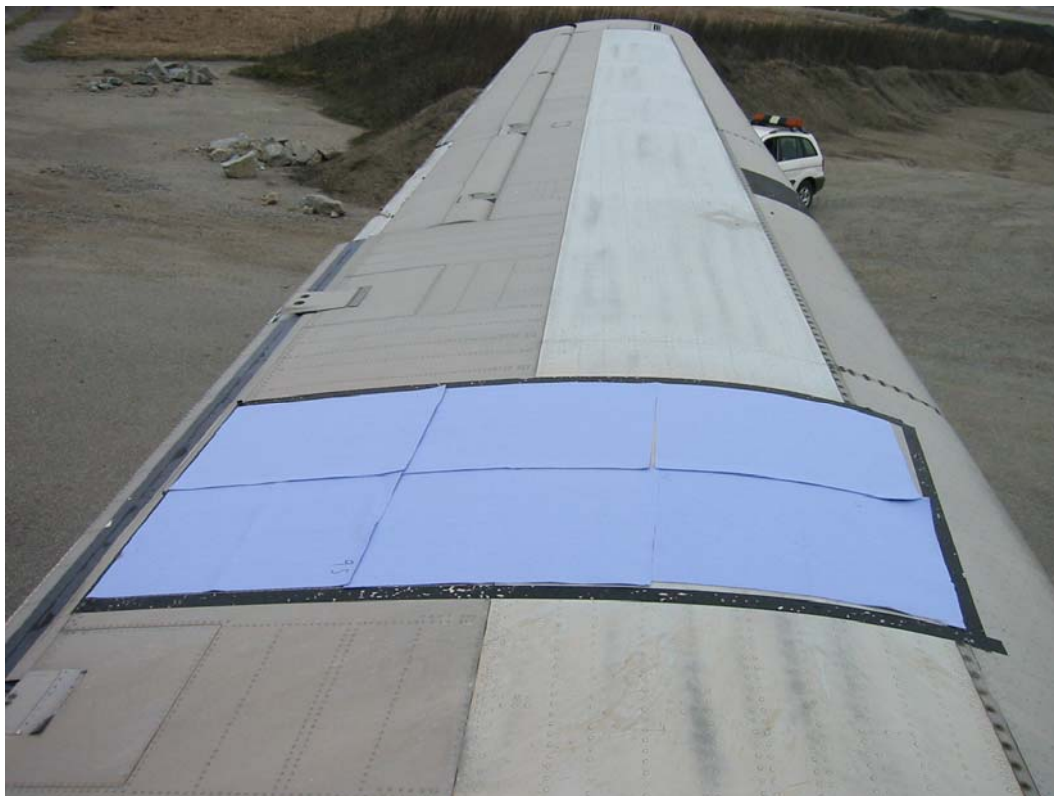
Figur 8: Provyta på vinge för bestämmandet av avisningsvätskans filmtjocklek, på Bromma flygplats år 2004. Flygplanet till vilket vingen tillhör är ett Convair. (Foto: L.Marklund)
