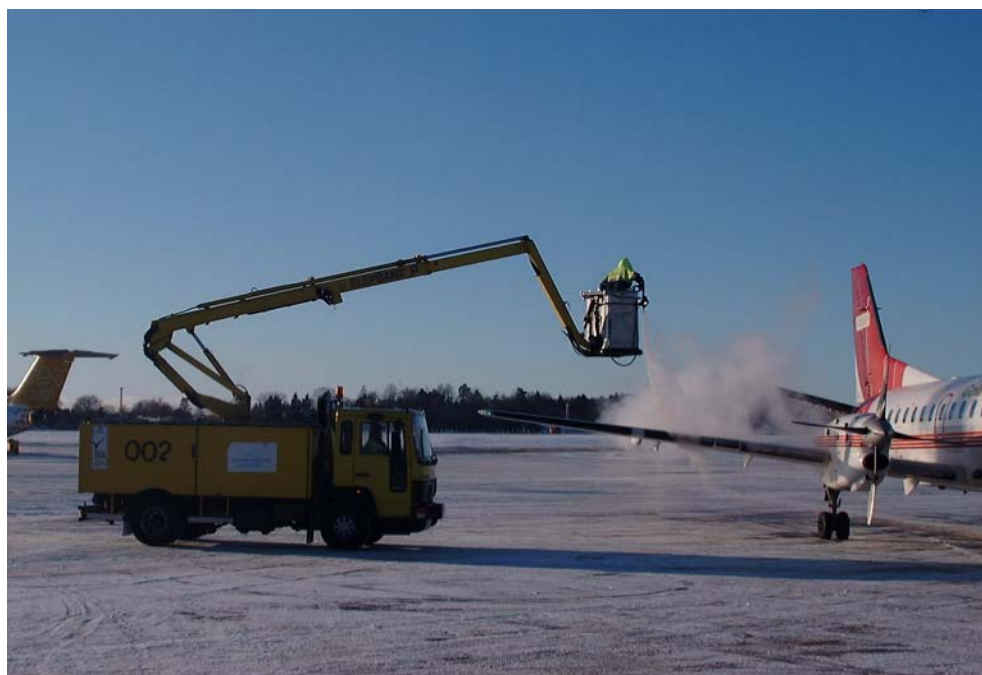
Figur 1: Avisningsfordon med öppen bemannad lyftkorg som genomför en avisning på Bromma flygplats år 2003. (Foto: L. Marklund)
