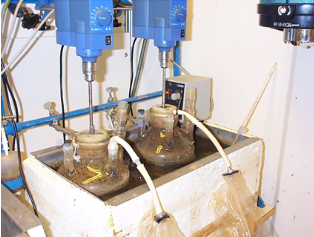
Figur 3. Utrustning för satsvisa utrötningsförsök.
