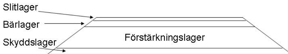
Figur 2.4. En vägs överbyggnad består av fyra olika lager (Vägverket, 2004).
