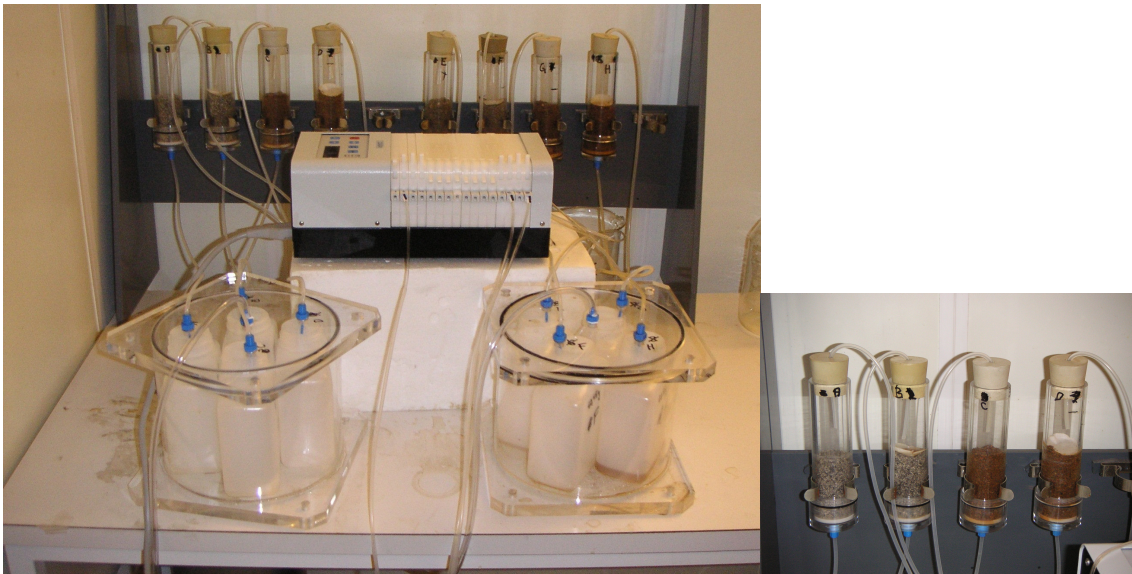
Figur 6. Uppställningen för kolonnförsöket med slangpumpen i mitten, tryckkamrarna med uppsamlingskärl längst fram och kolonnerna i bakgrunden. Till höger en närbild av de fyra kolonnerna avsedda för dagvatten.
