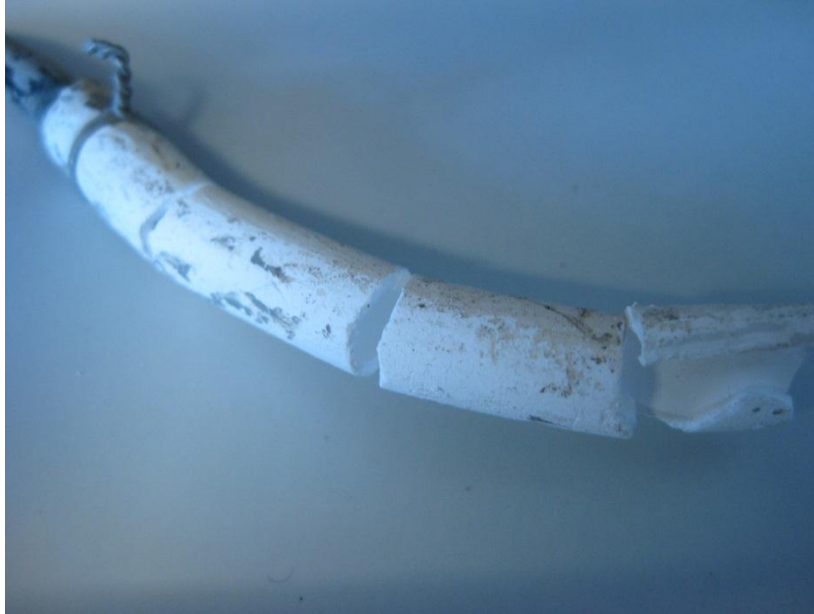
Figur 10. Närbild på membranslangen från mätslinga 4. Membranet hade vittrat och kritade kraftigt.
