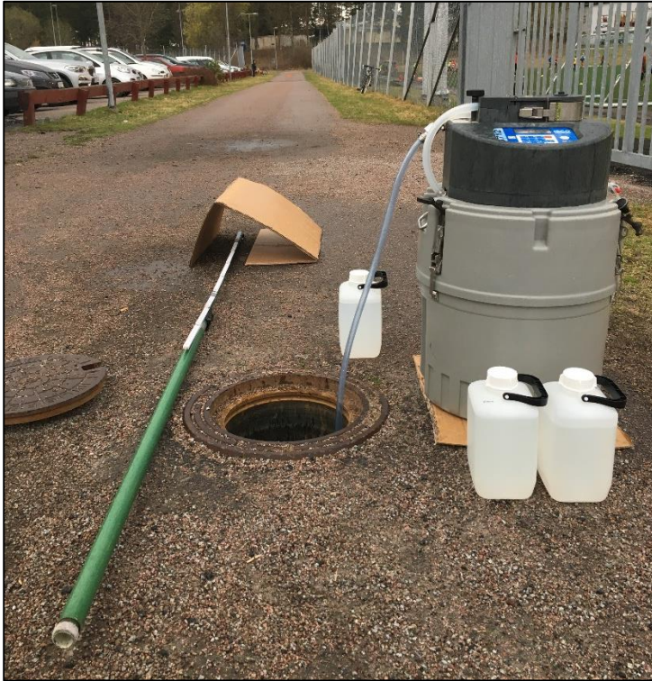
Figur 5. Provtagning av dagvatten vid Stenhagens IP (2018-06-21) med hjälp av provtagaren Teledyne ISCO 6712C. Mätning av vattenflöde utfördes med provtagningsstaven och ett blankprov togs genom att fylla en dunk med milli-Q-vatten.
