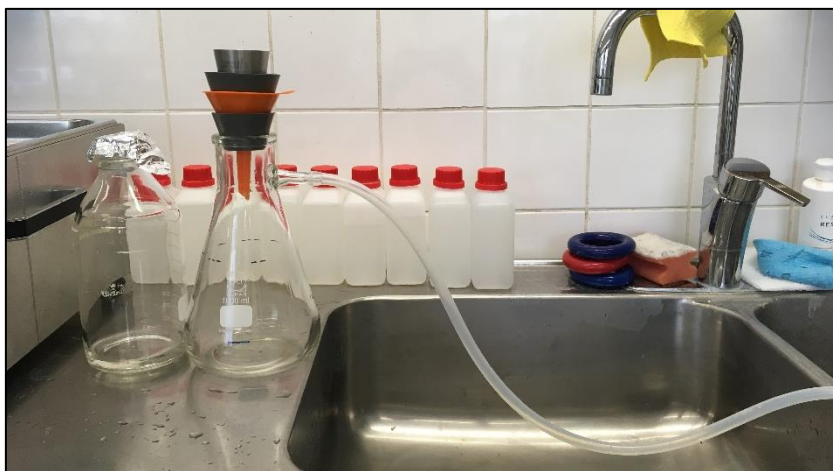
Figur 6. Mätuppställning med milli-Q-vatten i glasflaska, filterkolv med gummitätningar och plasttratt samt en ansluten slang.
