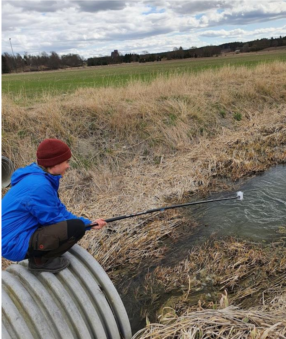
Figur 3.2: Vattenprovtagning i vägtrumman på Nyborgsvägen med en Ruttnerhämtare.
