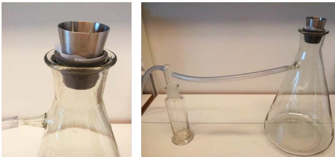
Figur 2: Experimentuppställning med ett filter med porstorlek 100 mikrometer placerat mellan en gummimanschett och metalltratt (vänster). Gummimanschetten placerades på en 5-liters filtrerkolv som med en gummislang sammankopplades med en vakuumflaska (höger) och vakuumsug.
