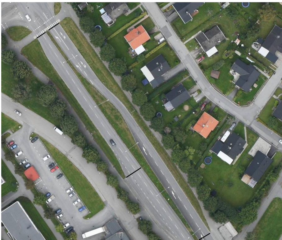
Figur 4. De två områdena intill vägen kan användas till dagvattenhantering utan att lutningen av vägen behöver byggas om. Markeringarna visar de vägsträckor som är beräknade att kunna leda vatten till grönytorna (Stadsbyggnadskartan, 2013-03-14).
