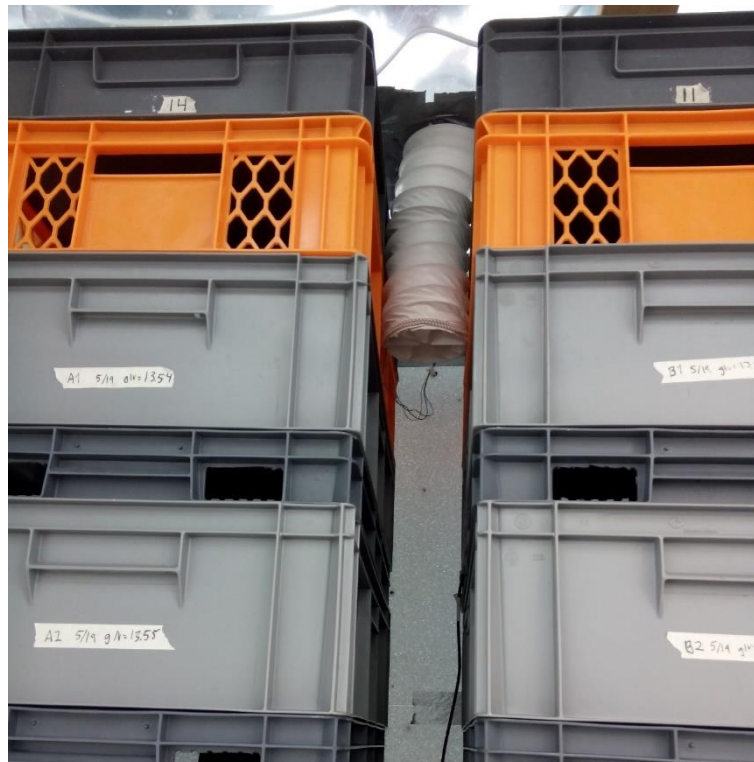
Figur 8. Stapel A och B, sett framifrån, med en luftspaltsback och tom behandlingslåda ovanpå de översta behandlingslådorna. I figuren syns också luftinloppet mellan dem som går ned till översta luftspaltsbacken (orange).
