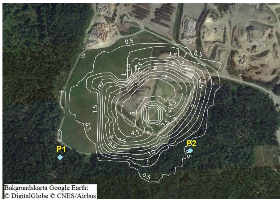
Figur 20: Närbild på etapp 1 med skillnaden i meter i grundvattennivåer mellan simuleringarna med och utan sluttäckning. 3 m betyder att grundvattennivån är 3 m lägre efter sluttäckning jämfört med innan.
