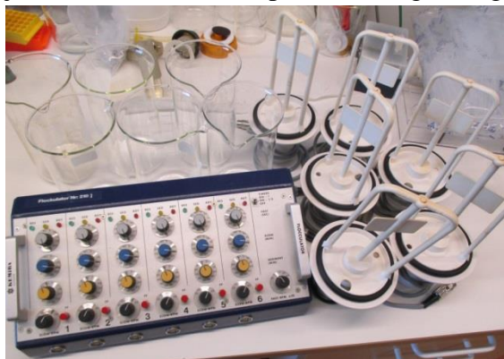
Figur 19. Flocculator med enlitersbägare och omrörare.
