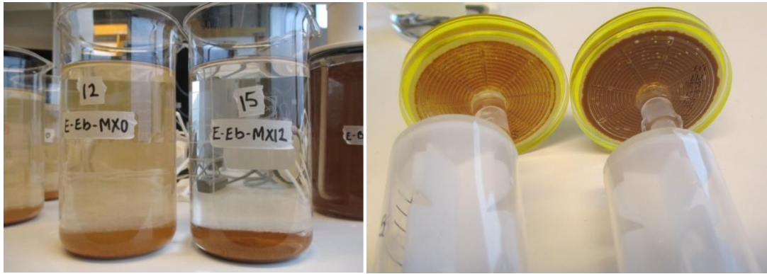
Figur 32. I bilden till vänster har proverna sedimenterat i fem minuter. Den vänstra bägaren innehåller ny MIEX ® och den högra använd MIEX ® . I bilden till höger visas två sprutor med filter som använts för att filtrera provet. Den vänstra sprutan för ny MIEX ® och den högra använd MIEX ® .
