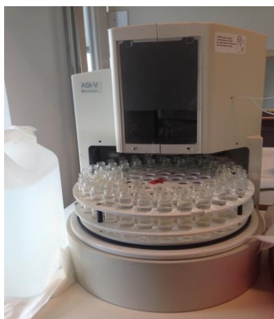
Figur 18. Autosamplern till DOC-instrumentet.
