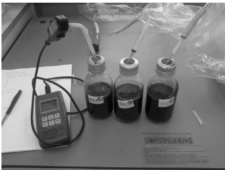
Figur 11. Från vänster: Tryckmätning, provtagning för GC-analys och tömning av biogas.
