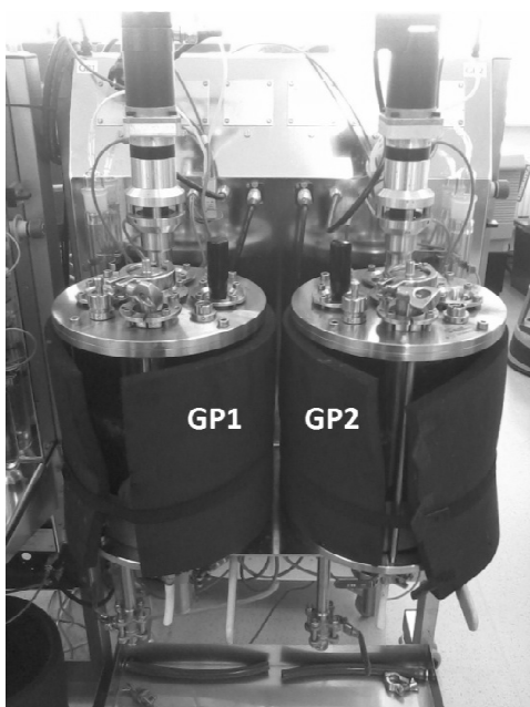
Figur 5. De två biogasreaktorerna, GP1 och GP2, som användes för det kontinuerliga försöket.
