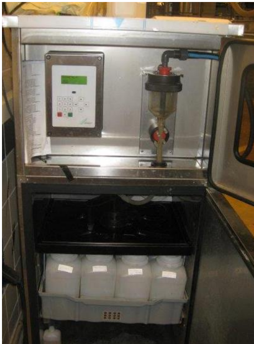
Figur 11. En av tre provtagare som användes för insamling av vatten under mätkampanjen.
