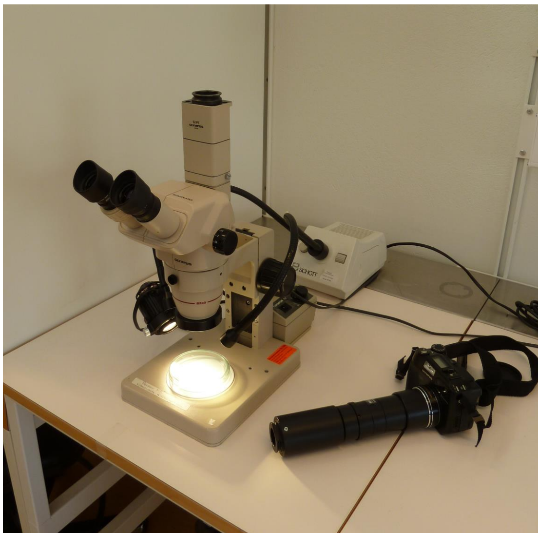
Figur 12. Stereomikroskop med extra sidobelysning och tillhörande digitalkamera. Foto: Robert Jönsson.
