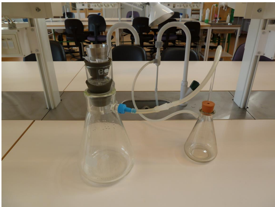
Figur 11. Filteranordning kopplad till vakuumsug för filtrering av insamlade vattenprover. Vid filtrering hälldes vattnet genom den rostfria ståltratten med fastmonterat 20 µm-filter som hölls på plats med en rostfri ståltråd. Foto: Robert Jönsson.
