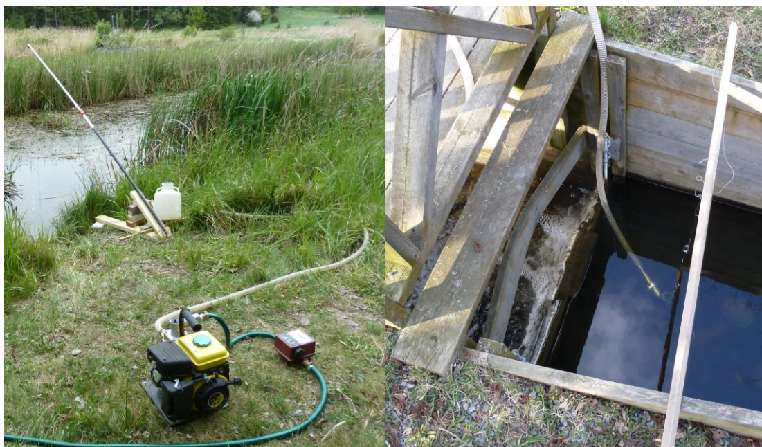
Figur 14. Provtagning i fält. Den vänstra bilden visar en provpunkt i våtmark Alhagen. Där hålls filterhållaren på ett konstant djup med hjälp av en förlängningsbar stav placerad i en stödjande träställning. Till höger är hållaren upphängd i en trästav som placerats över utloppet från Korsängens vattenpark. Foton: Robert Jönsson.
