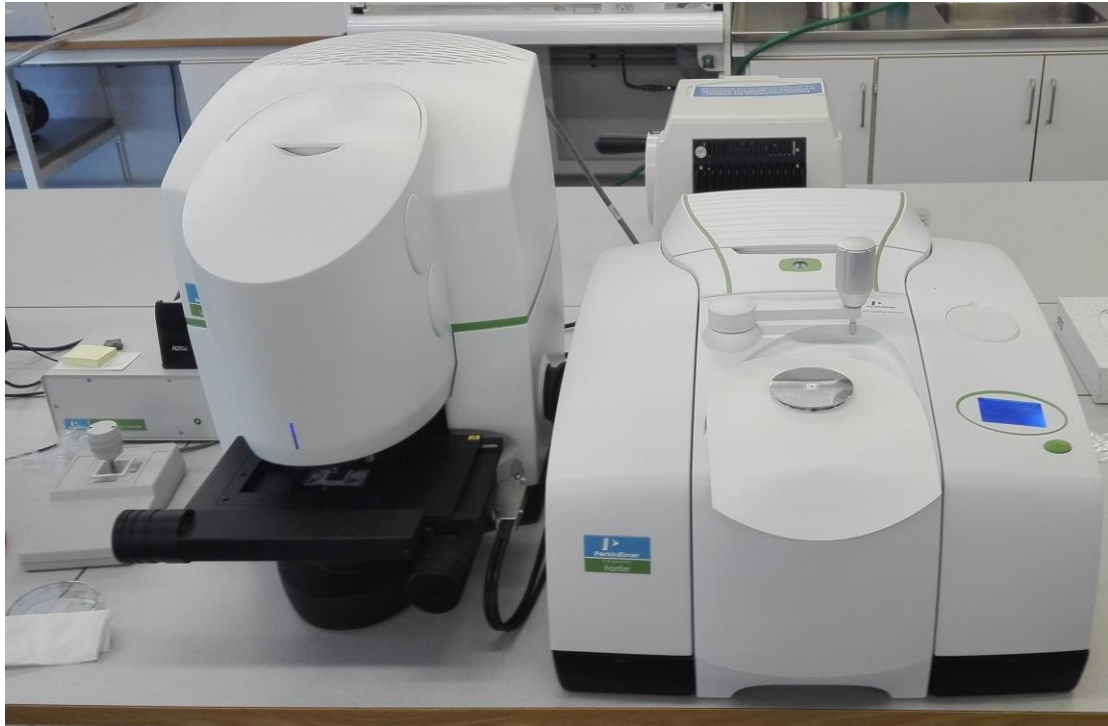
Figur 13. Perkin Elmer Frontier FT-IR Spectrometer. Foto: Robert Jönsson.
