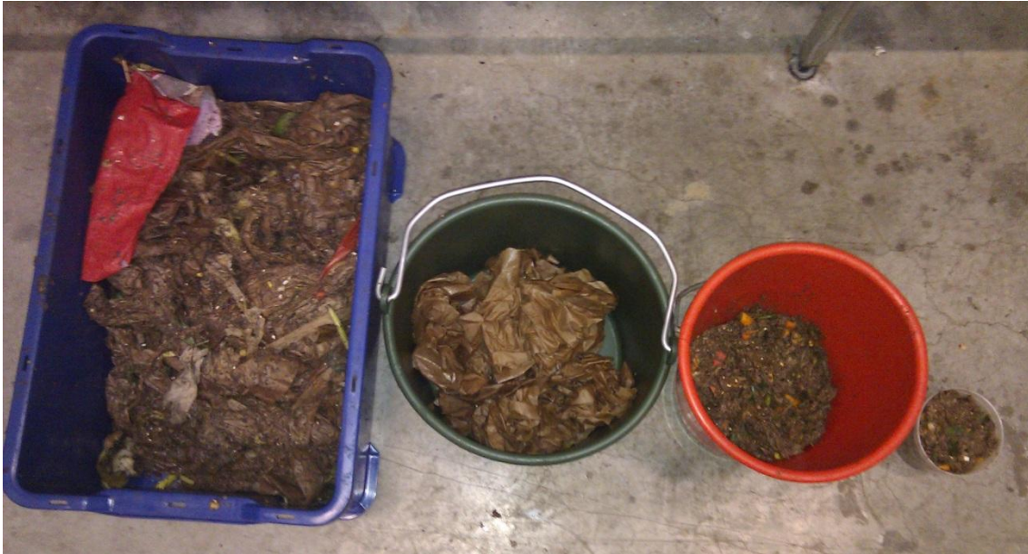
Figur 14 Rejektfraktioner från biogasanläggningen Kungsängens gård. Den blåa backen innehåller pappersrejekt från provpunkt 4 (figur 13). De två hinkarna i mitten innehåller två utsorterade fraktioner, påsar respektive övrigt material. Den lilla burken till höger innehåller övrigt material som ska analyseras.
