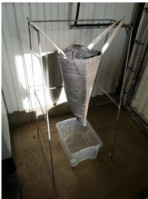
Figur 10: Foto på försöksuppställning för test av 3 × 5 liter slam. Påsen gjord av geotextil.
