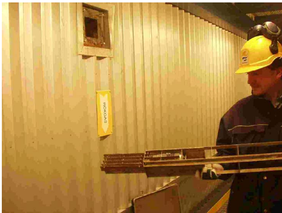
Figur 2 Exponering av provbänk i Johannes. En provbänk är en hållare för små katalysatorprover. Proverna syns till vänster om handen.
