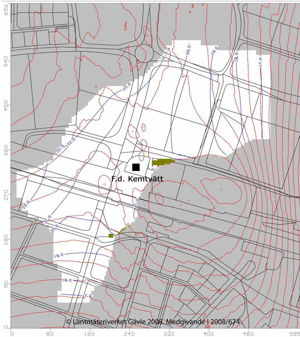
Figur 2. Jämförelse mellan beräknad (blå linjer) och interpolerad (röda linjer) ekvipotentialkarta för modellager 2. Mellan varje linje ändras grundvattnets totalpotential 1 m. Gröna områden anger celler som gått torra under simuleringen, vitt område anger aktivt modellområde och grått inaktivt.
