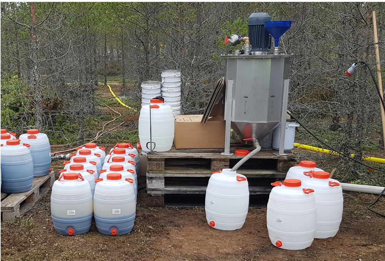
Figur 3 Foto av dispersionsenhet i plåt med blå tratt, samt 25 L plastdunkar med koncentrerad nZVI-slurry.
