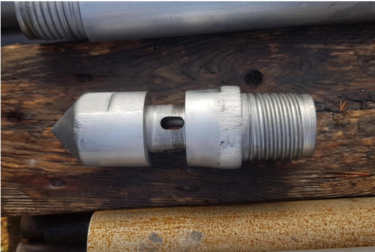
Figur 4 Injekteringsmunstycket som användes vid injektering av nZVI-slurry.
