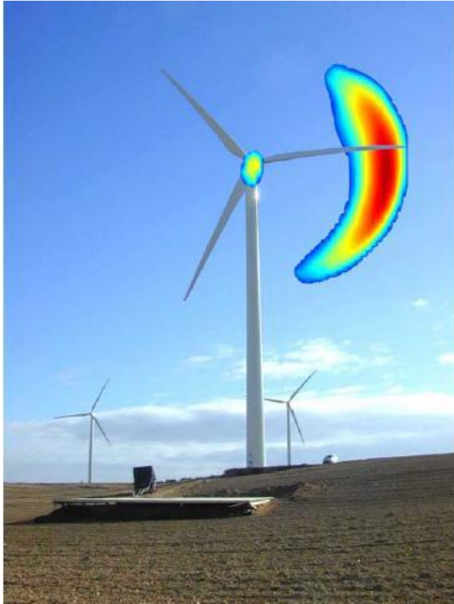
Figur 7. Bild av vindkraftverk med ljudkällorna i rotorplanet projicerade (Schepers, 2005).
