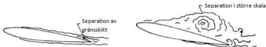
Figur 11. Separation av gränsskiktet från ytan (efter Brooks, 1989).
