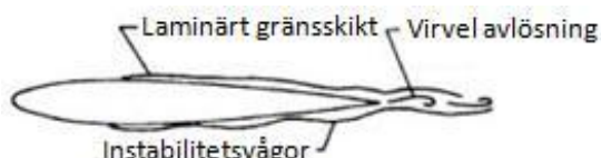
Figur 9. Laminär strömning i bladets gränsskikt (efter Brooks, 1989).
