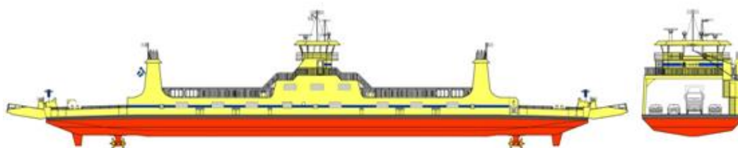
Figur 11 Illustration av en frigående färja, 340 Venus. Färjan har drivpropellrar och ramper i för och akter. Bottenskrovet (den röda nedre delen av färjan) är djupgående och rymmer färjans motorer. Färjans övervattenskrov är den delen av färjan som är över vattenytan (den gula övre delen av färjan). Styrhytten är belägen centralt över bildäck (Bild: FKAB/Trafikverket Färjerederiet).
