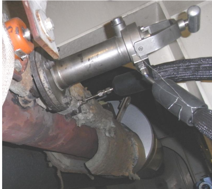
Figur 1 Inkopplad mätutrustning där slangen i förgrunden leder till gasapparaturen och slangen i bakgrunden leder till partikelapparaturen.
