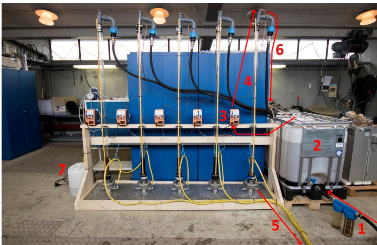
Figur 3: Kolonnuppställning, kolonner numrerade från höger, bestående av ett filter (1), mellanlagringstank (2), pump (3), kolonn (4), slangen (5) till utloppet. En mellanlagringstank infann sig även mellan kolonn 4 och 5 (7). Utlopp (6) ledde bort vatten vid backspolning. Adsorbenterna som användes var Cyclecarb 401, Brennsorb 1240 och Purolite 694E.
