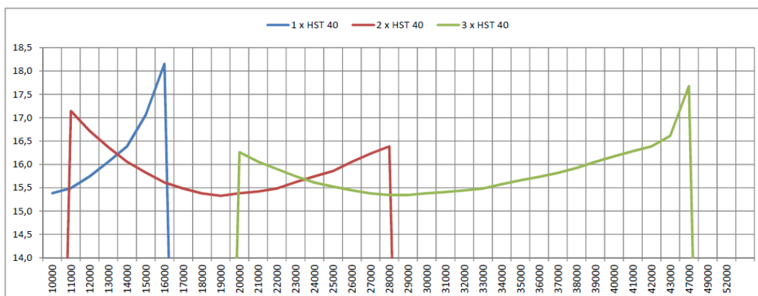
Figur 1 Optimal körning av 3 stycken HST40 (Wh/m 3 på Y-axeln, Nm 3 /h på X-axeln).
