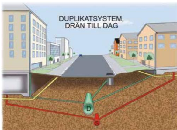
Figur 3: Duplikatsystemets utformning. Gröna ledningar leder dagvatten, röda spillvatten och gula husgrundsdränering (Svenskt Vatten AB 2016a, med tillstånd).
