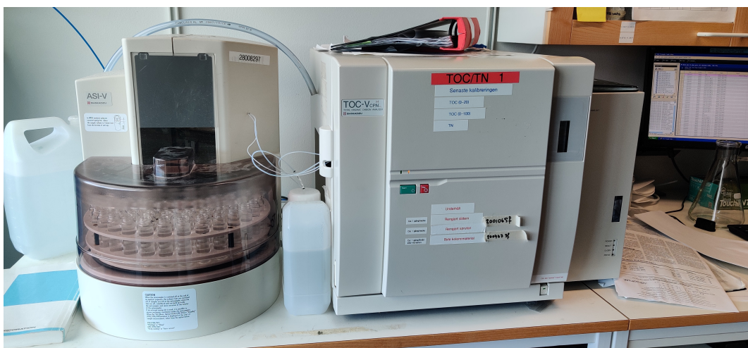
Figur 9: Instrumentet som användes för att mäta TOC-halterna.
