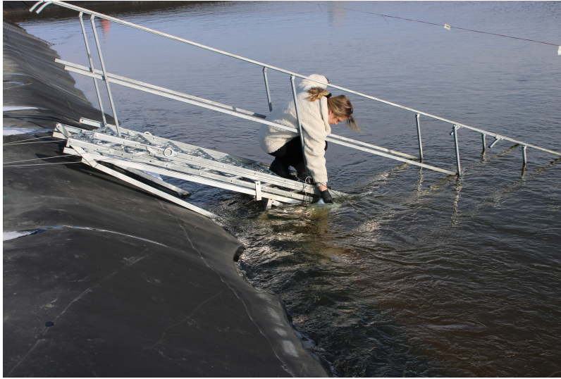
Figur 6: Provtagning vid KDA damm 5, två stycken 2-litersdunkar sänktes ner under ytan på damm 5.
