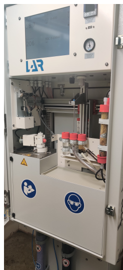
Figur 7: LAR-maskinen som användes för TOC-mätningar.
