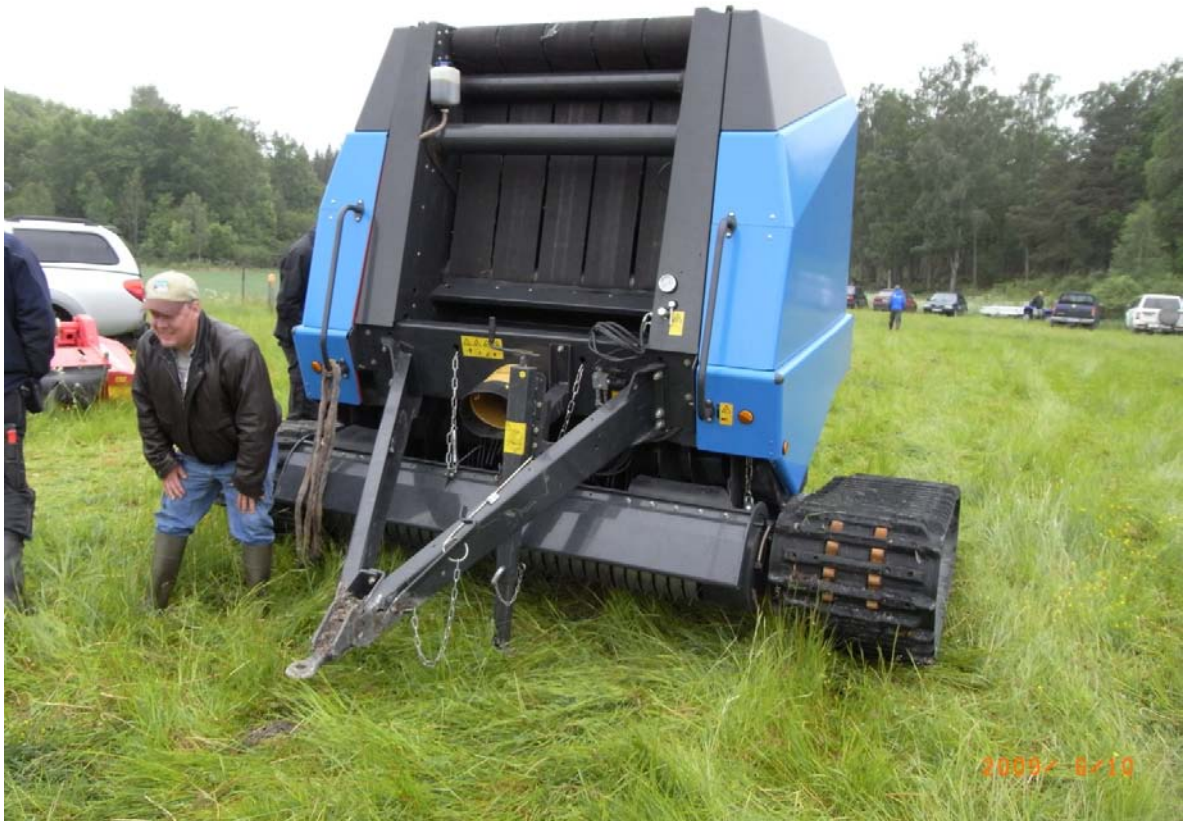
BILD 5. SPECIALUTVECKLAD RUNDBALSPRESS AV VÄSTMANLANDS LÄNSSTYRELSE. (FOTO: MARVIN MARTINS).
