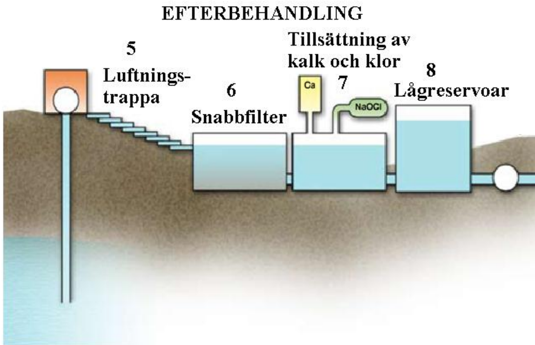
Figur 3. Efterbehandling efter upptag av konstgjort grundvatten. Modifierad illustration (EEM 2007).
