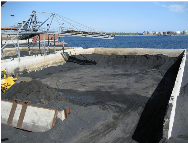
Figur 2.4 Järnsandsupplaget. På bilden håller avvattningsbassängen på att tömmas på järnsand.
