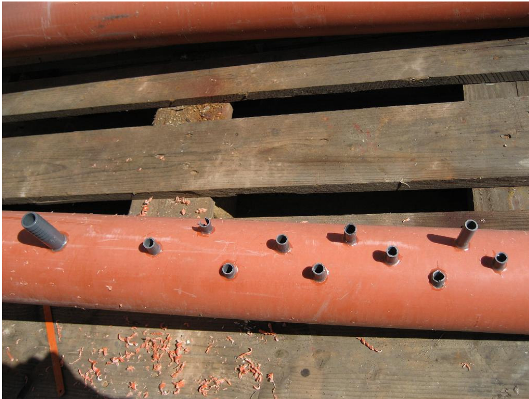
Statisk mixer. Kalkflödet leds in i röret längst till höger.
