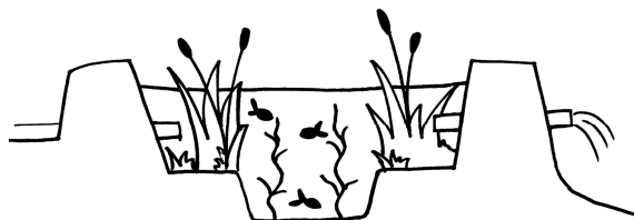
Figura 12 humedal artificial con dos zonas de vegetación y una zona de agua abierta en la mitad – un método para tratar desagüe. Ilustración Maria Persson
