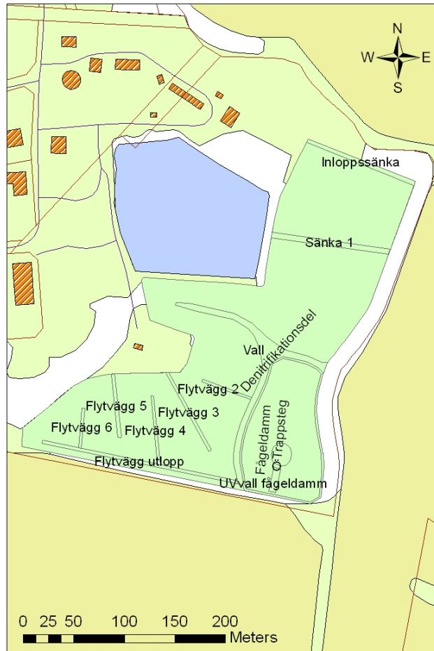
Figur 18. Beskrivning av modell R3, där flytväggar ska få vattnet att slingra sig igenom den södra delen av våtmarken.
