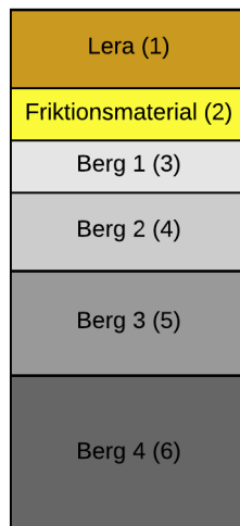
Figur 11. Konceptuell jordlagerföljd, siffrorna inom parentes anger lagernummernummer. Den vertikala utsträckningen är inte skalenlig.
