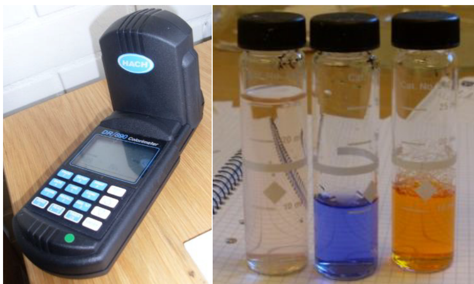
Figur 2.2.2 Vänstra bilden HACH kolorimeter DR 890. Den högra bilden: Längst till vänster är ett prov av tvåvärt järn, mitten totaljärn och till höger total mangan.
