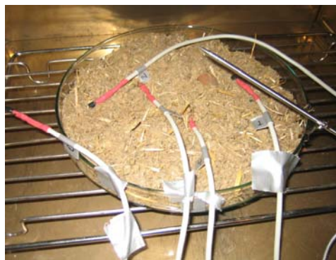
Figur 5. Hygienisering av torkat bioavfall i låg glasskål i laboratorieugn. På bilden syns även temperaturgivare kopplade till dator samt en termometer.
