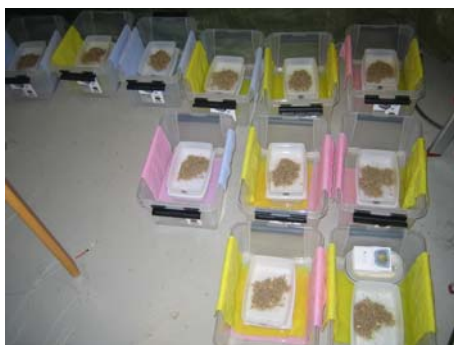
Figur 6. Uppställning mögeltest, i hög luftfuktighet, innan locken lades på lådorna.
