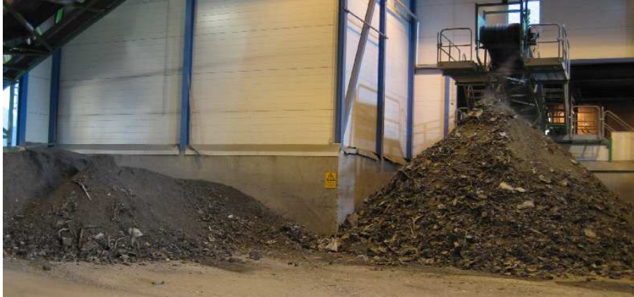
Figur 3. Slaggen som bildas efter förbränning av avfallsbränsle. Här illustreras att slaggen innehåller en hel del skrot.
