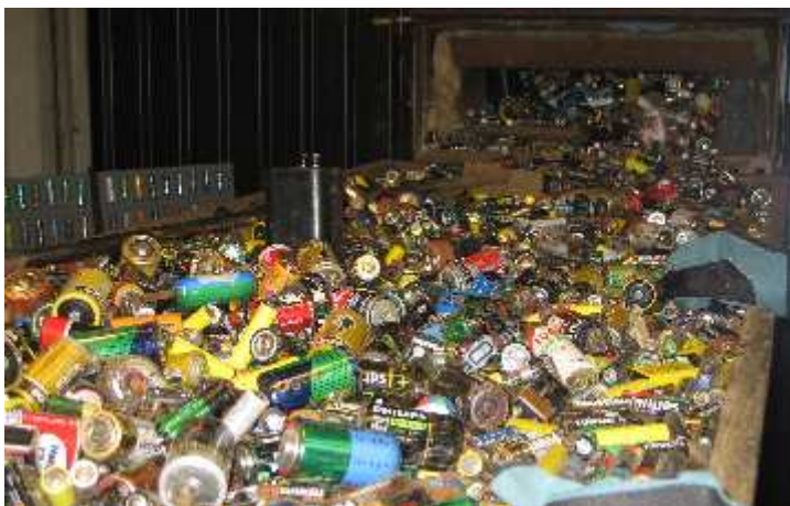
Figur 11. Sortering av batterier vid återvinningscentral. I rännan finns en blandning av alla typer batterier bland annat NiCd-batterier och NiMH-batterier.
