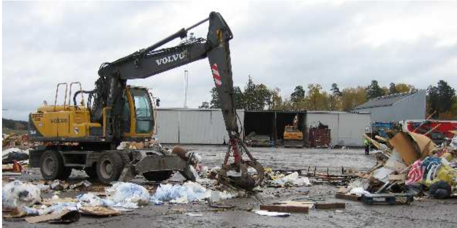
Figur 20. Grävmaskin utrustad med sorteringsgrip, används vid sortering av industriavfall.
