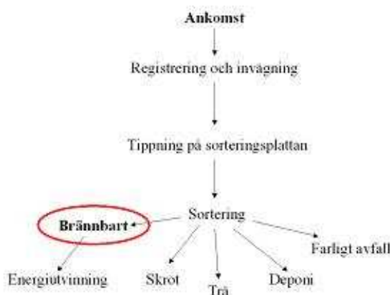
Figur 24. Flöde på anläggning C
