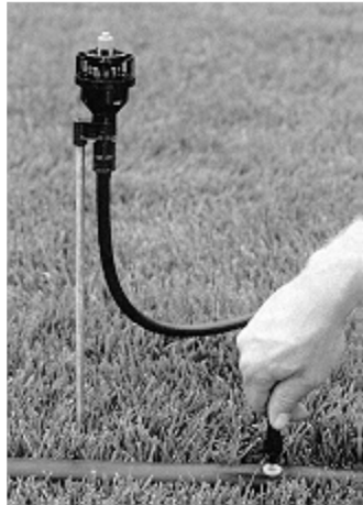
Figur 4. Bevattningssprinkler (tv) och Bevattningskanon (th) som används för recirkulering vid Häradsuddens deponi, Norrköpings kommun.
