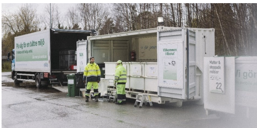
Figur 9 SÖRABs mobila återvinningscentralen som åker runt i Norra Stockholm. På bilden ses lastbilen för farligt avfall, den öppningsbara containern med mindre behållare, containerflaket för skrymmande avfall samt personal på plats (pers. komm., Tjärnhell, 2017).
