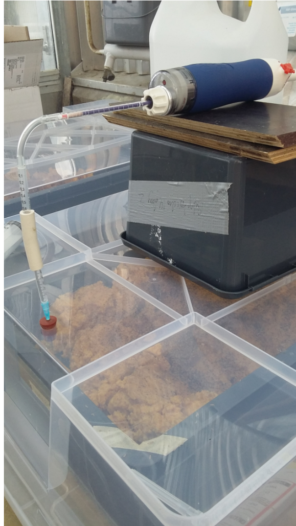
Figur 5: Bild på gasmätning av CO 2 från apelsinskal med reagensrör kopplat till en pump (Kitagawa Gas Detector).
