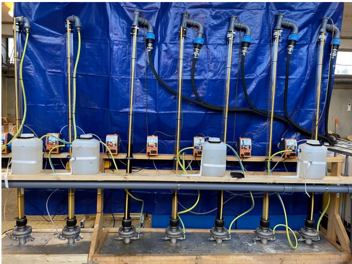
Figur 4. Kolonn uppställning numrerade från höger till vänster, för innehåll i respektive kolonn K1-K7 se Tabell 2.
