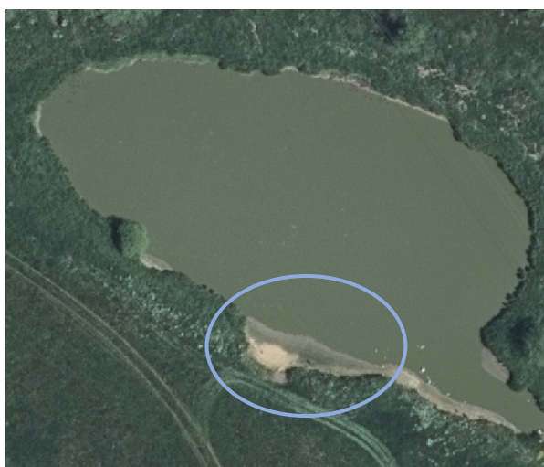
Figur 22. Erosion längs strandkanten vid våtmarken Bälteberga C1. Blå cirkel markerar utfodringsplats av änder där erosion skett. Bakgrundskarta: Ortofoto RGB 0,25m 2020 © Lantmäteriet
