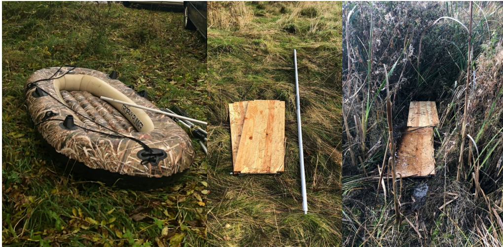
Figur 5. Fältarbets utrustning. Från vänster: uppblåsbar båt, plankor och mätpinne samt ett exempel på hur plankorna användes under fältarbetet. (Foto: Louise Lumsén).
