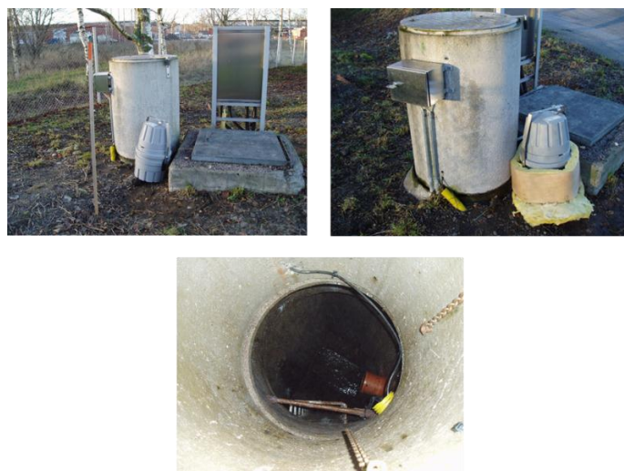
Figur 6: Högst upp, till vänster; Andersbergledningens nedstigningsbrunn. Högst upp, till höger; provtagaren, XIAN 1000, isolerad. Längst ner, centrerad; det avloppsvatten som provtas.
