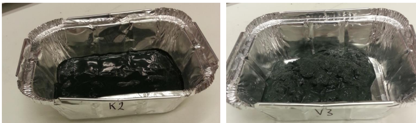
Figur 16. Bestämning av vattenkvot, de blöta proverna torkades i 105 °C till konstant vikt. Till vänster i bild prov från Köping och till höger prov från Västerås.
