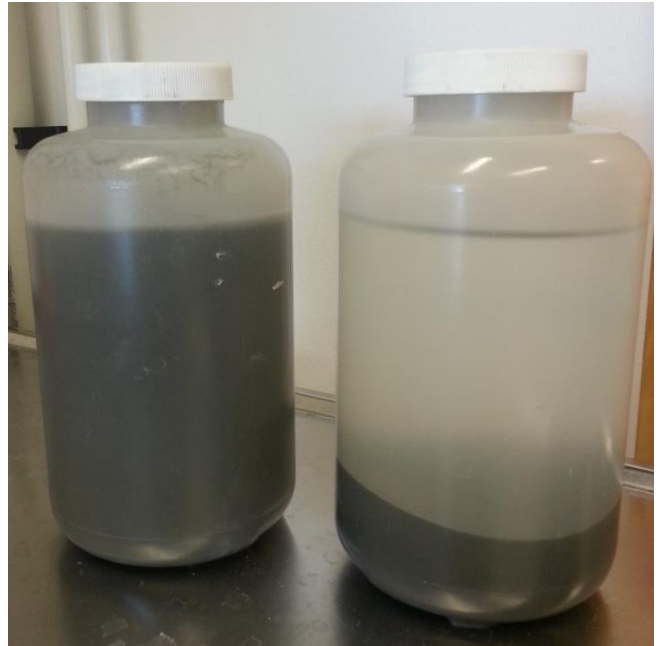
Figur 18. Till vänster: skakapparat som användes vid tvåstegs skakförsök. Till höger: proven centrifugerades för att kunna ta ut vatten för analyser. Flaskan till vänster innan centrifugering och flaskan till höger efter centrifugering.
