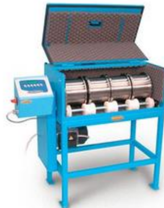
Figur 6. Maskin som används vid användning av Micro-Devalmetoden för bestämning av nötegenskaper (Nycander, 2014).
