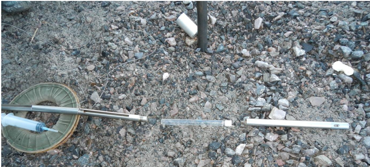
Figur 14. Provtagare i fält med provtagningsbehållare i glas i mitten och dubbeländig kanyl till höger.
