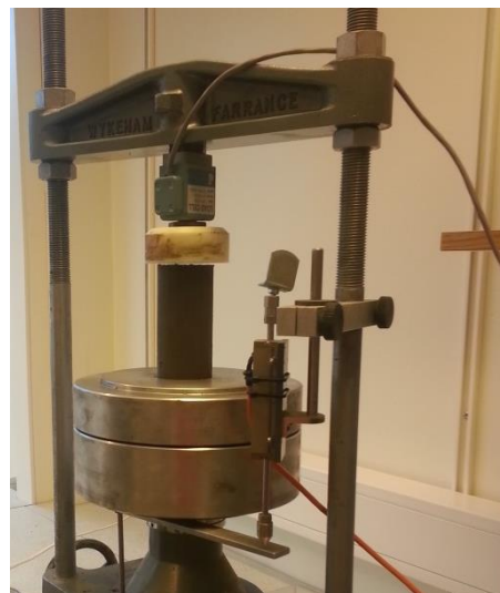
Figur 7. Uppställning för enaxligt tryckförsök på SGI i Linköping.
