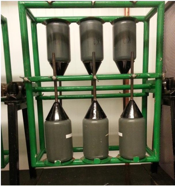
Figur 18. Till vänster: skakapparat som användes vid tvåstegs skakförsök. Till höger: proven centrifugerades för att kunna ta ut vatten för analyser. Flaskan till vänster innan centrifugering och flaskan till höger efter centrifugering.
