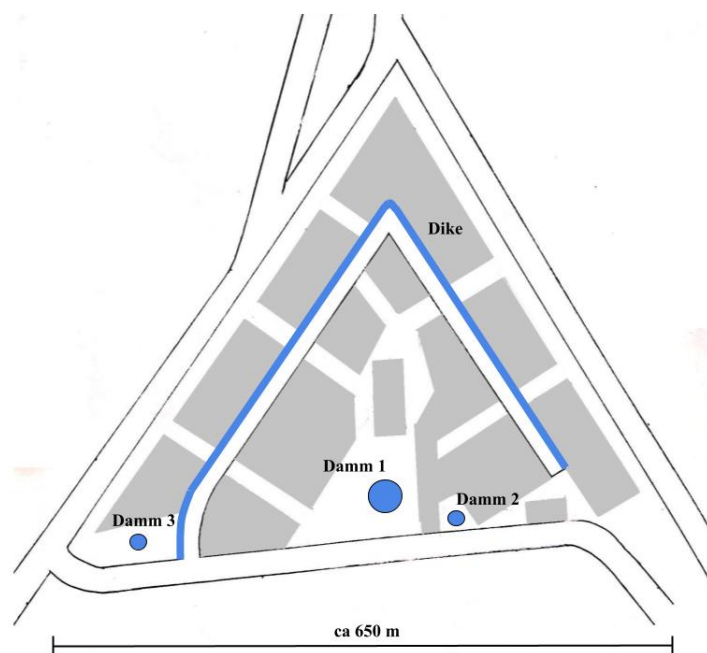
Figur 7: Ungefärlig placering av tekniklösningar i Scenario Torra dammar. Tekniklösningarna är inte skalenligt utritade. Diket är markerat med blått streck. Grå markering i figur visar ungefärlig yta som planeras att hårdgöras. Skissen är inspirerad av illustrerat planförslag i dagvattenutredning (Andersson 2018).
