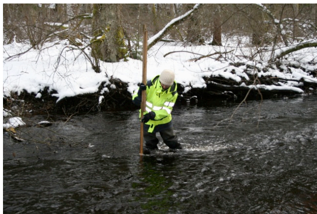
Figur 12. Mätning av vattendjupet i Lagan nedströms Götaforsdammen. Djupmätningarna utfördes mitt i vattendraget med hjälp av en latta och vadarstövlar. Foto: Joakim Holmbom, 2013.
