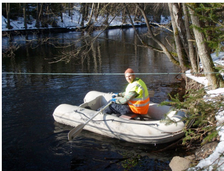
Figur 15. Denna bild visar inmätningen av tvärsektion C belägen i den högra kanalen. Djupmätningarna utfördes från gummibåt med hjälp av ett lod. Foto: Lisa Carlsson, 2013.
