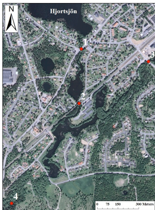
Figur 11. Platserna där djupmätningarna utfördes. Vid punk 1, 2 och 3 utfördes djupmätningarna från broar med hjälp av en latta. I området kring punkt 4 utfördes djupmätningarna med hjälp av vadarstövlar och en latta. ©Lantmäteriet, medgivande i2012/921.
