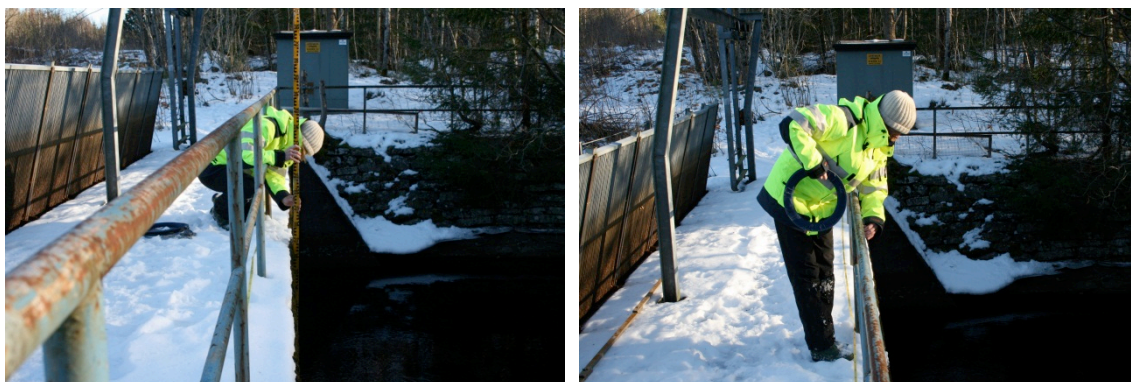
Figur 14. Inmätning av tvärsektion D belägen i den vänstra kanalen. Foto: Joakim Holmbom, 2013.
