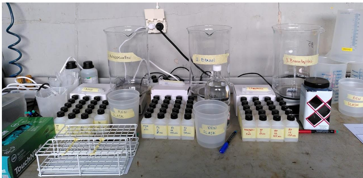
Figur 7. Försökupställning med förberett material. På bilden syns tre batcher (2L-glas cylindrar) på varsin magnetomrörare, provflaskor i plast, kärl för rengöring, lådor med nylonfilter (0,45 \mu\text{m} porvidd), engångssprutor och diverse utrustning.
