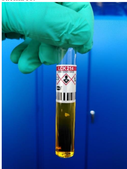
Figur 10. Förmodad utfällning i en av COD-kyvetterna (LCK 214).
