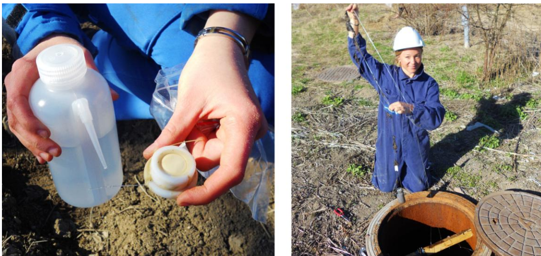
Figur 11 Till vänster visas den passiva provtagaren PSM-1 Metaller och till höger visas monteringsanordning med fiskelina och ankare (foto Linnea Henriksson och Reza Safaee).
