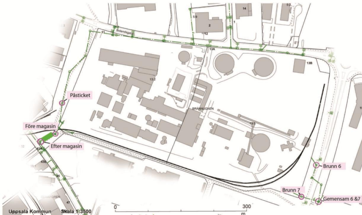
Figur 9 Dagvattenledningar utanför kvarteret Brännugnen med provtagningspunkter.
