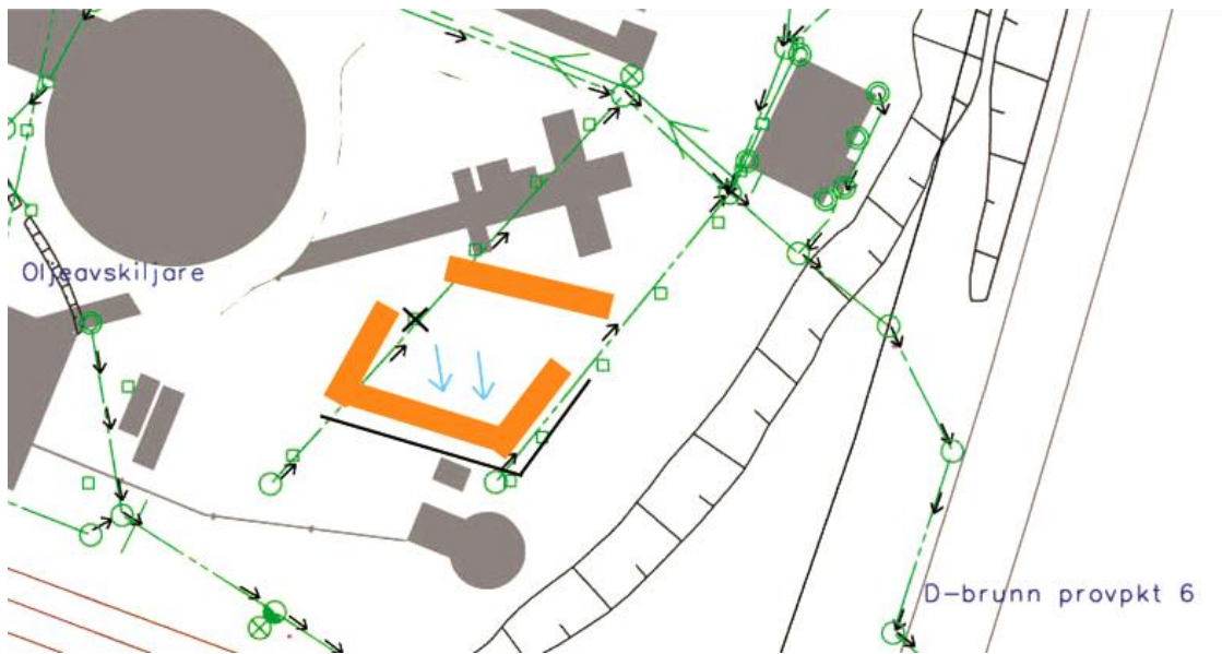
Figur 24 Förslag på inhägnad med containrar och rännor för hantering av fuktig torv. De blåa pilarna visar den önskade riktningen på dagvattnet ovan mark och de svarta pilarna visar dagvattnets riktning i dagvattennätet. Dagvattennätet är de gröna linjerna.
