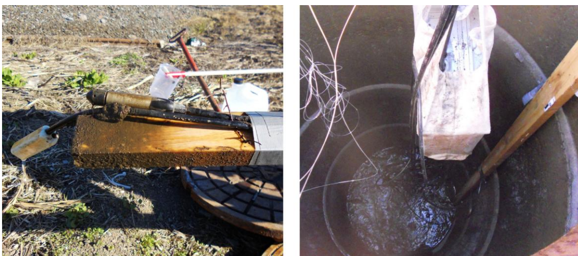
Figur 12 Tryckgivare, konduktivitetmätare och loggerlåda i tygpåse monterad i dagvattenbrunnen (foto Linnea Henriksson).
