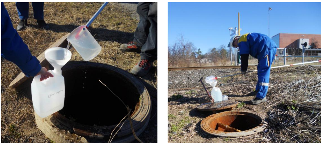
Figur 10 Bägare med tillhörande skaft samt dunk och tratt för stickprovtagning (foto Linnea Henriksson).
