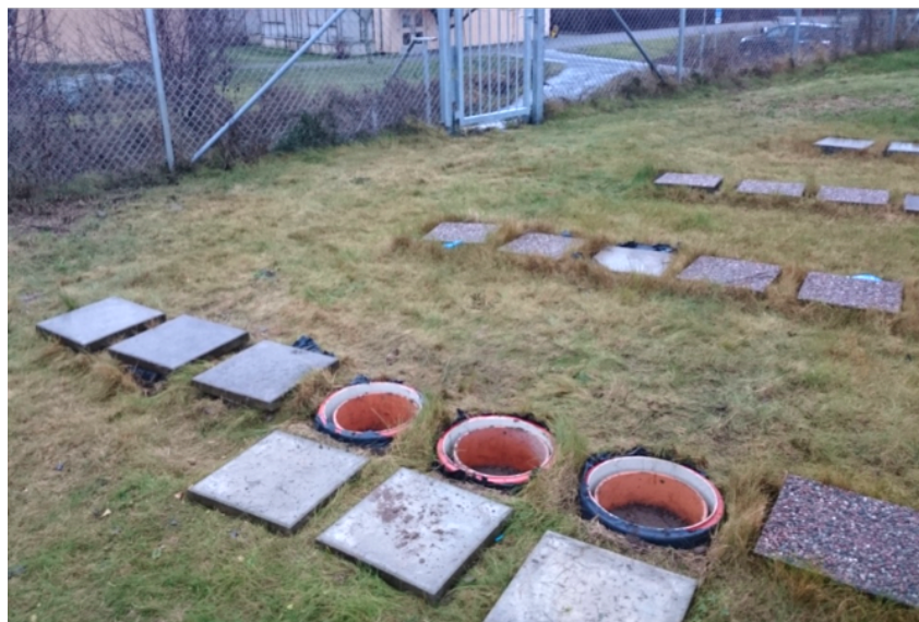
Figur 3. Lysimetterör vid lysimeteranläggningen. Foto taget av Dan Berggren Kleja.
