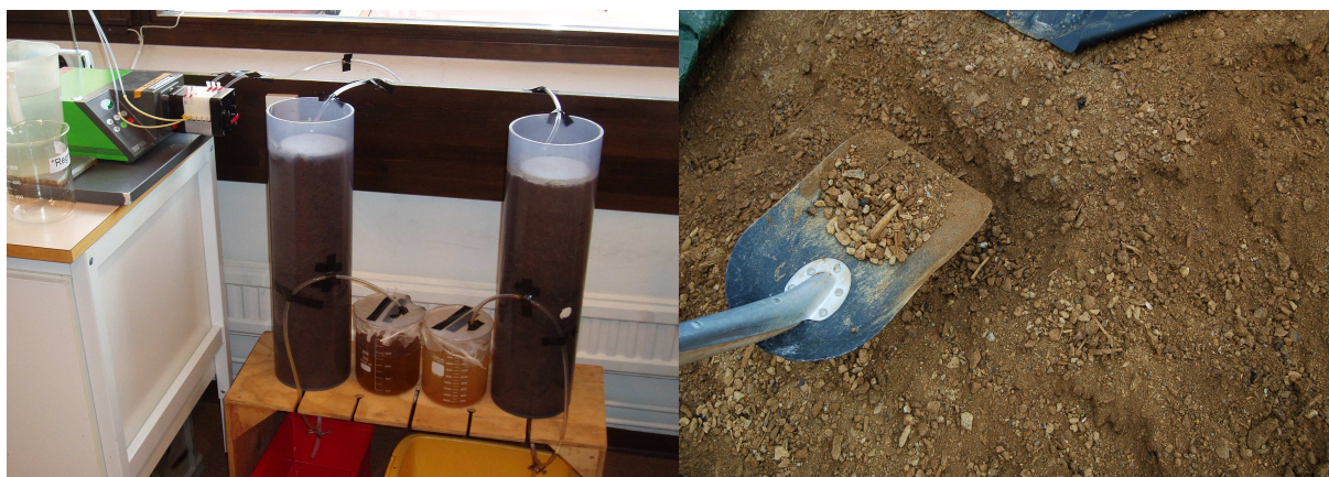
Figur 3.4. T.v. kolonntestets försökuppställning. T.h. Det utvalda materialet för testerna.
