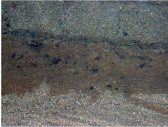
Figur 26. Kanten på långsamfilter. Observera den bruna randen på sanden.
