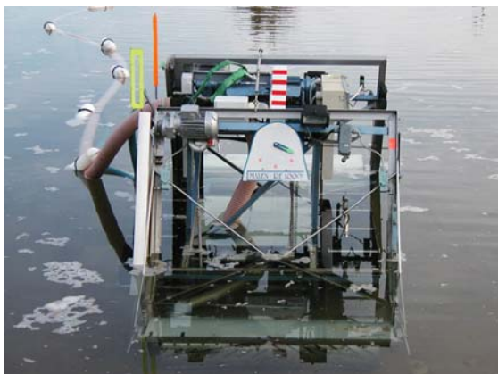
Figur 12. Rensarroboten MALEN RF1000.
